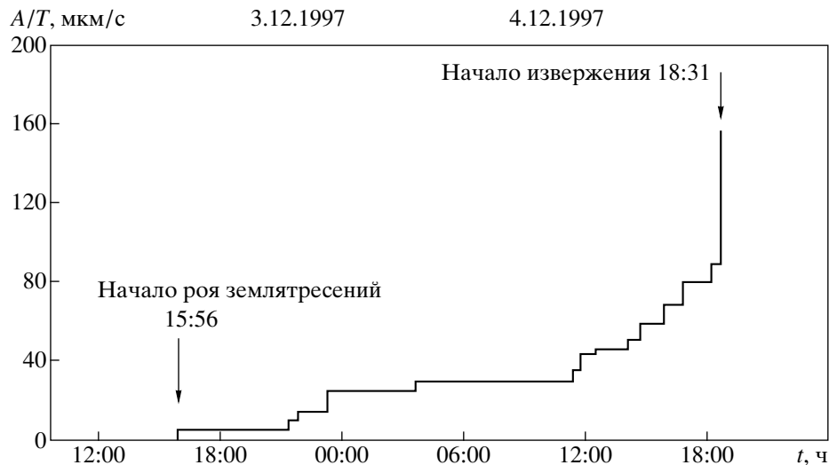
Рис. 3. График накопленных деформаций (A/T)_{\max} в рое вулканических землетрясений.
